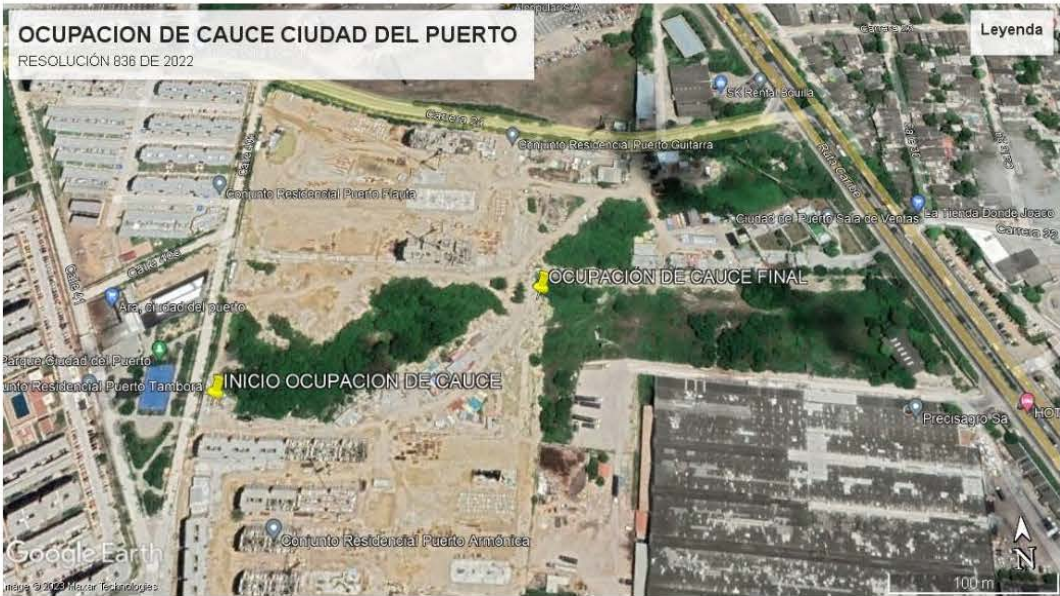
Ilustración 1 Imagen satelital de la ocupación de cauce del tramo tributario del Arroyo el Salao
